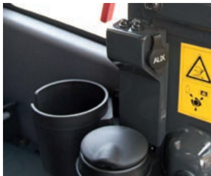
Entrée auxiliaire (fiche MP3) et porte-gobelets
