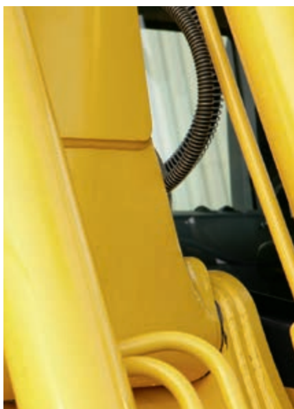
Pied de la flèche en acier moulé
