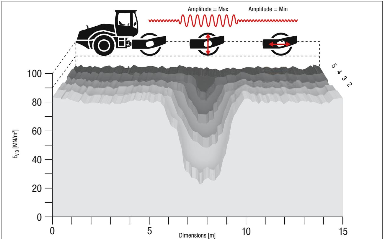
VARIOCONTROL adapte automatiquement l'amplitude au degré de compactage.
