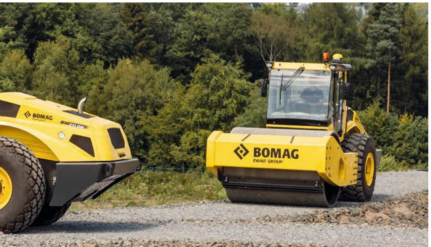
Fiable même dans les conditions les plus difficiles : avec le contrôle de patinage manuel de la version D et la double pompe de la version H, BOMAG définit de nouveaux critères en matière d'aptitude en pente pour ses rouleaux monocylindres.
