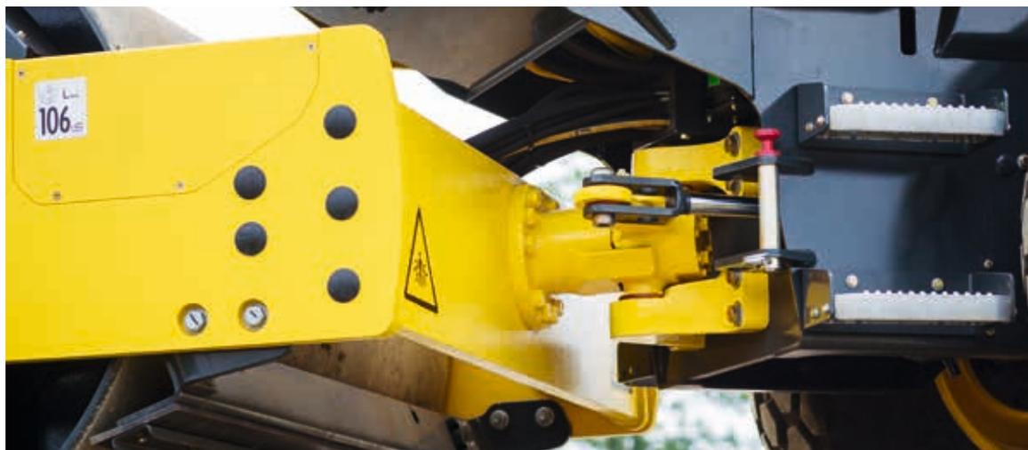
L'as de la propreté : l'articulation ne nécessite aucun entretien et la machine fonctionne sans la moindre lubrification.
