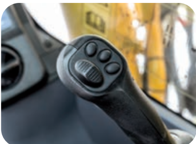
Praktische, ergonomische en precieze bediening dankzij de joysticks met proportionele controleknop voor de hulpstukken
