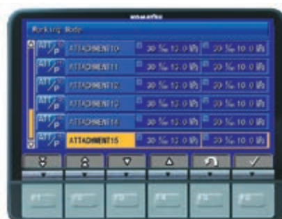
Contrôle des Accessoires Intégré Komatsu (KIAC)
